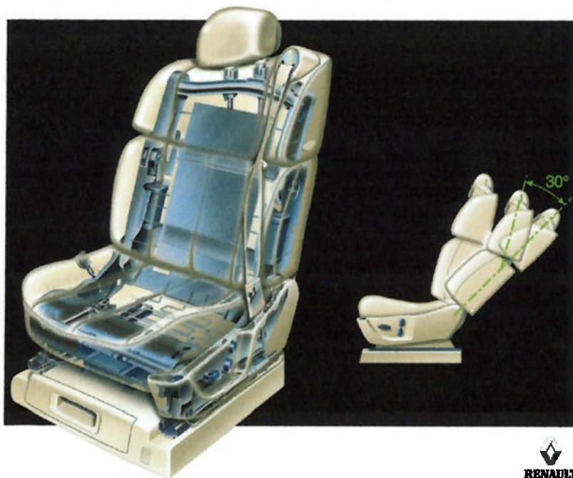
Figura 12: Banco com ancoragens do cinto de segurança integradas (Renault Vel Satis)
