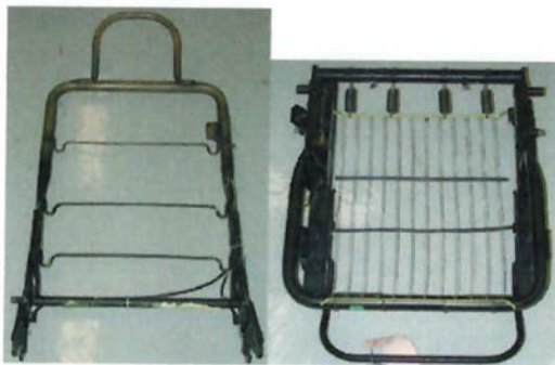
Figura 16: Estrutura tubular (Chevrolet Celta)
