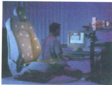
Figura 35: Digitalização do contorno do banco (Keiper)
