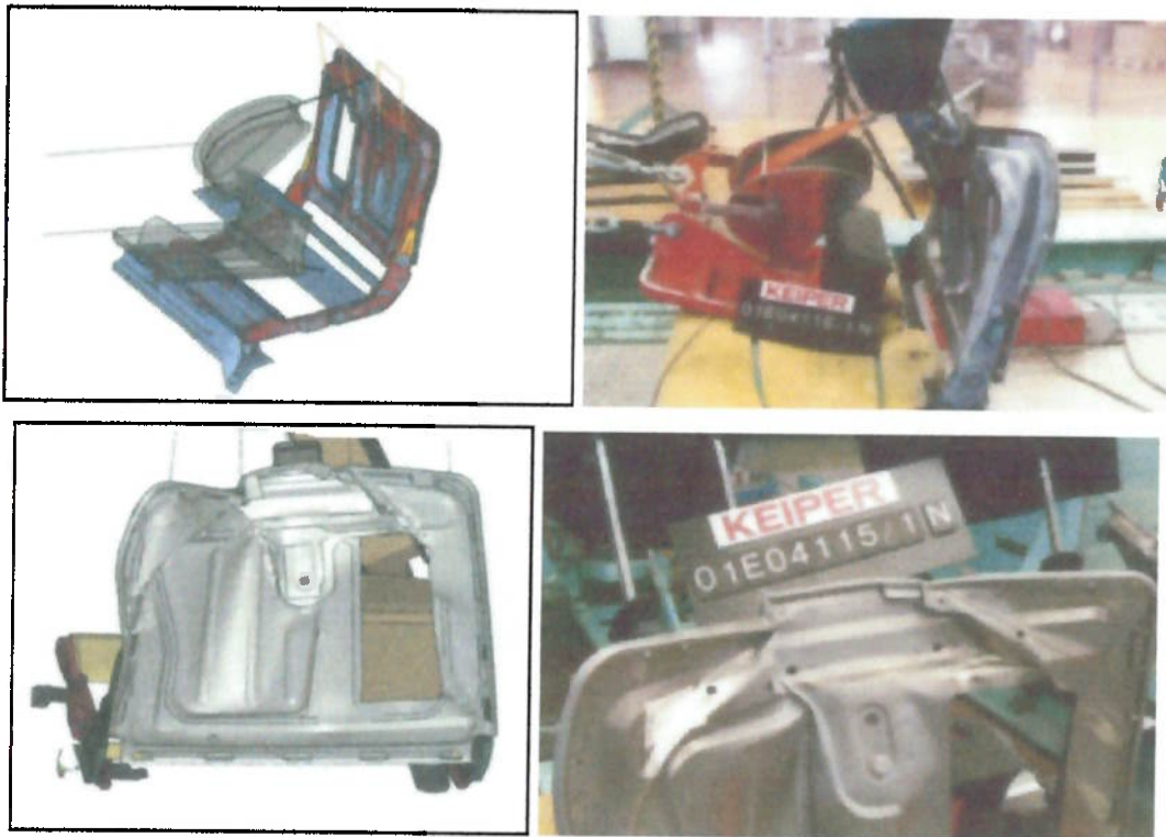
Figura 36: Simulação de teste de ancoragem do cinto de segurança (Keiper)
