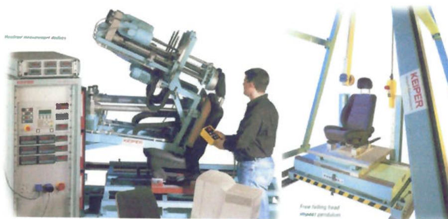
Figura 30: Testes de apoio de cabeça - estático e dinâmico (Keiper)
